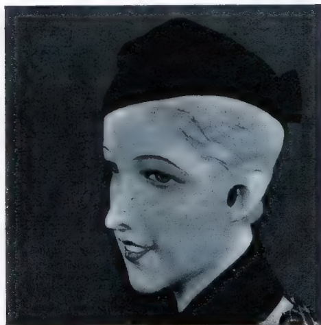
Bild 2 a. Der Puppenkopf mit den Mikrofonen statt der Ohren.
